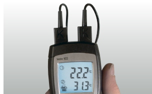
Současné snímání teplot ze dvou připojených sond a zobrazení diferenční teploty
